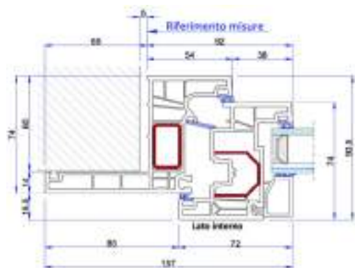
Telaio da ristrutturazione con aletta da 65 mm.
